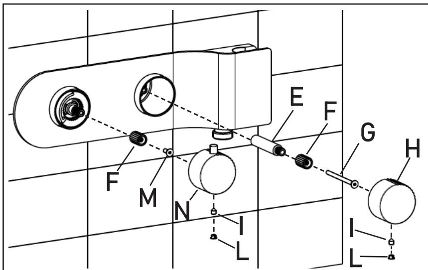
Rimuovere le placchette (L). Svitare i grani (I) con chiave a brugola da 2,5 mm e sfilare le manopole (N) e (H). Svitare le viti (M) e (G) con chiave a brugola da 2 mm e sfilare le prolunghe (E) e (F).
