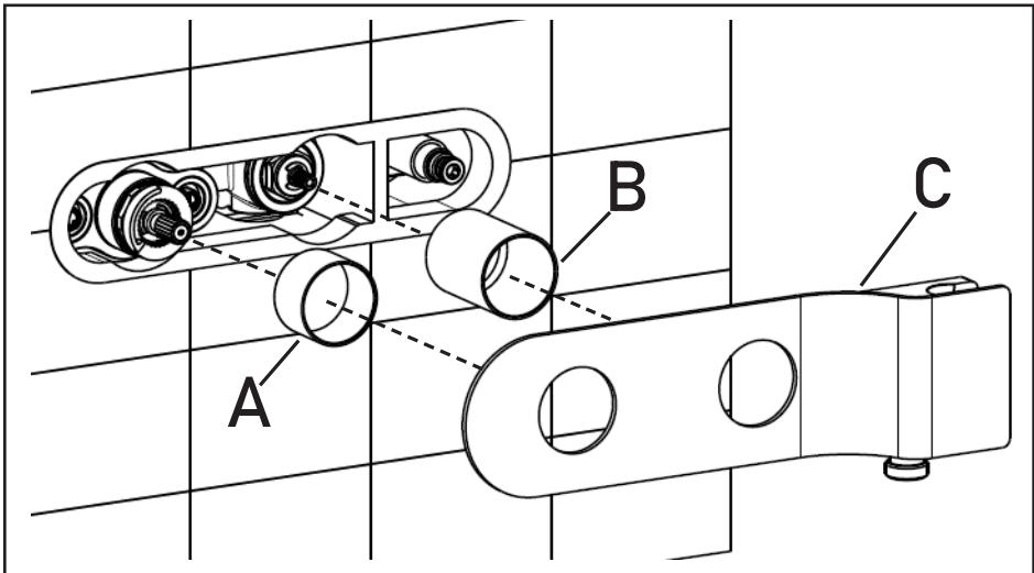
Avvitare ed inserire a mano le ghiere (A) e (B). Inserire la piastra (C) aggiungendo del silicone sul retro in modo da farla aderire alle piastrelle per evitare infiltrazioni di acqua all' interno del muro.
