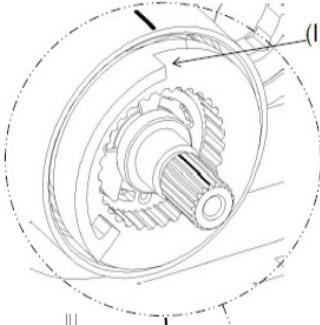
**ATTENZIONE:** prima di procedere con l'installazione verificare che la ghiera di limitazione della temperatura abbia l'indicatore (I) rivolto verso l'alto.
