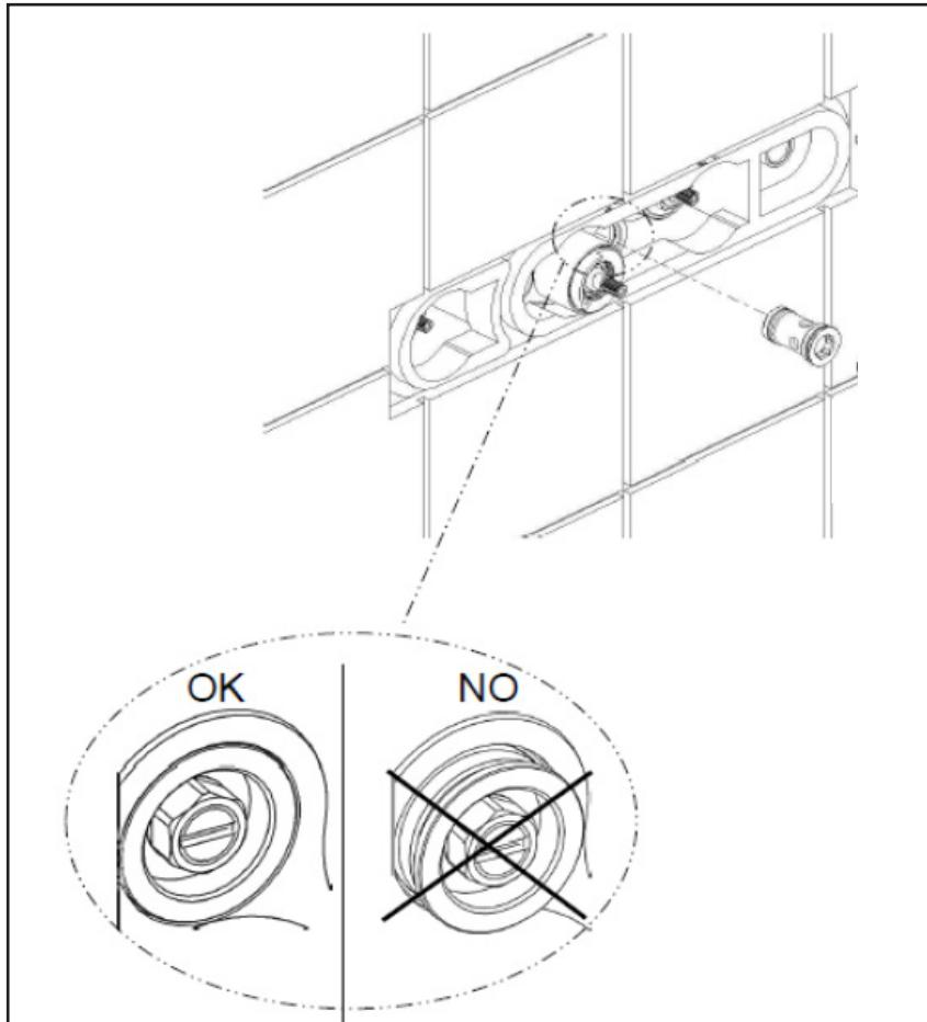
Chiudere gli ingressi dell'acqua fredda e dell'acqua calda. Svitare la valvola utilizzando una chiave a tubo da 10 mm. Pulire o sostituire la valvola. Riavvitare la valvola sul termostatico utilizzando una chiave a tubo da 10 mm fino in battuta.
