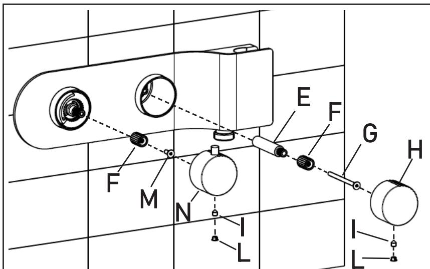
Montare le prolunghe (E) e (F) sulle aste delle cartucce e bloccarle tramite le viti (G) e (M) con chiave a brugola da 2,5 mm. Inserire le manopole (H) e (N) e bloccarle serrando i grani (I) con chiave a brugola da 2 mm. Inserire le placchette (L).
