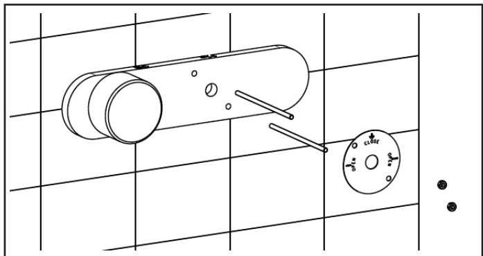
A rivestimento ultimato rimuovere la piastra di fissaggio svitando i dadi con chiave inglese da 7 mm e i tiranti filettati.
