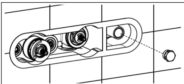
Rifilare la protezione e creare aperture per montaggio manopole e valvole.
