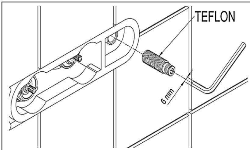
Avvitare il raccordo al corpo incasso con chiave a brugola da 6 mm, utilizzando canapa o simili per realizzare la tenuta idraulica.
