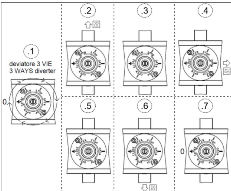
Collaudare l'impianto (pressione massima di prova 16 bar) nel modo indicato, in base al tipo di deviatore. Eseguire il collaudo in base alla sequenza numerata indicata.
