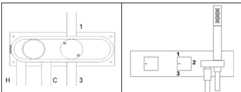
Inserire nella scanalatura il gruppo incasso con le protezioni montate, collegare le mandate delle acque (acqua fredda a destra, acqua calda a sinistra) ed eseguire l'impianto idraulico.
