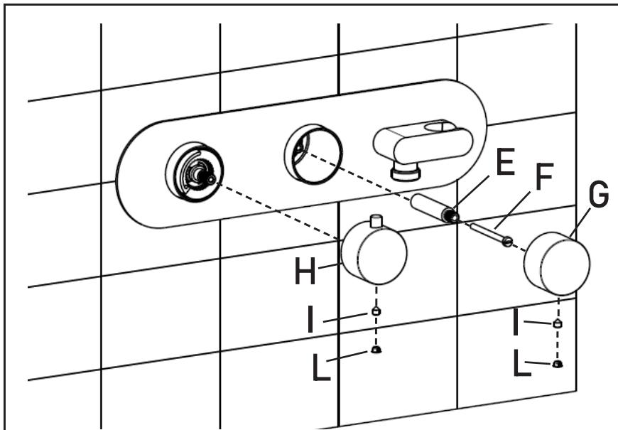
Montare la prolunga (E) sull' asta delle cartucce e bloccarla tramite la vite (F) . Inserire le manopole (G) e (H) e bloccarle serrando i grani (I) con chiave a brugola da 2 mm. Inserire le placchette (L).
