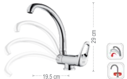
K42R Miscelatore monocomando monoforo 90° per lavello, con bocca alta girevole ed abbattibile, tipo lusso, modello sottofinestra. Single-lever one-hole sink mixer, with high spout swivel and foldable, luxury type, under window type.
