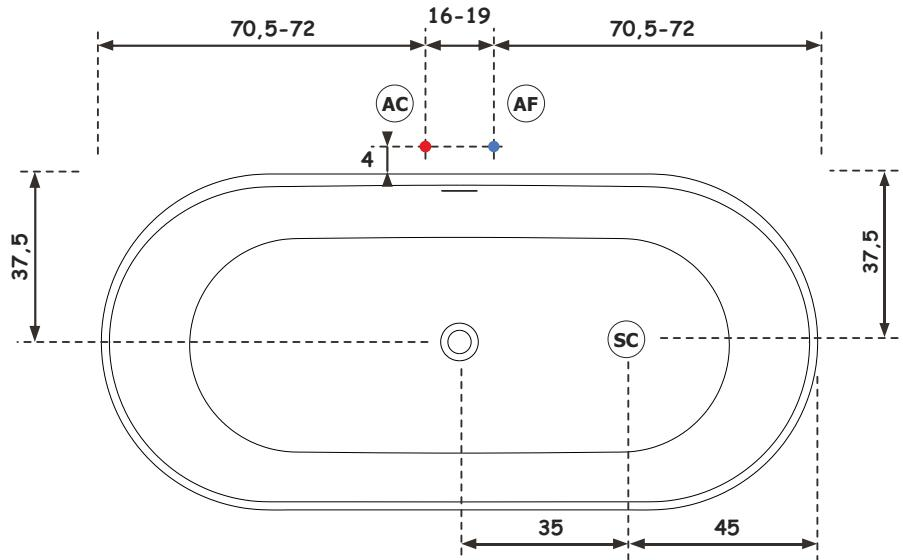
Allaccio acqua calda nel caso di vasca provvista di rubinetteria **(AC)** Hot water connection should the bathtub be fitted with taps
