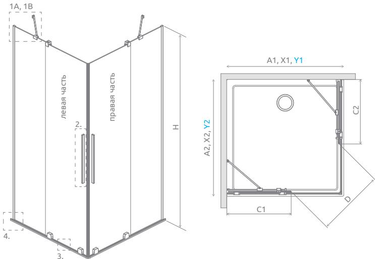
В случае монтажа на поддоне или бортик ванны, минимальная ширина плоской и ровной поверхности необходимой для монтажа составляет 43 мм, а её наклон не более 1 мм.
