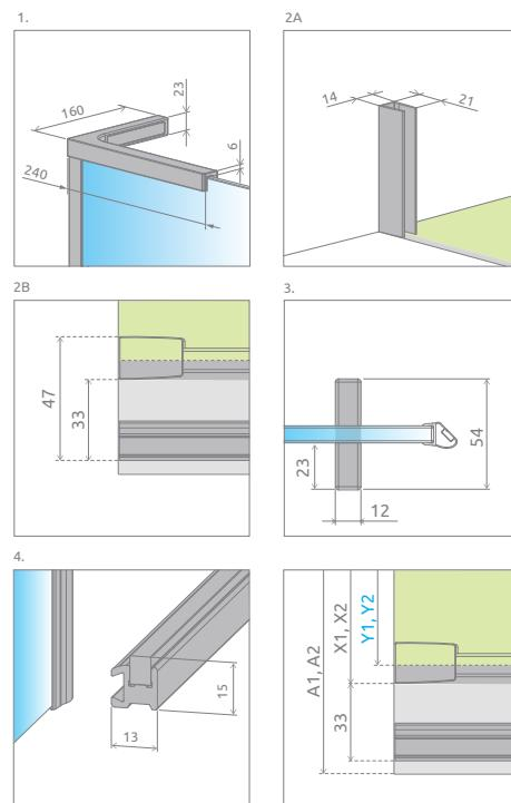
В случае монтажа на поддоне или бортик ванны, минимальная ширина плоской и ровной поверхности необходимой для монтажа составляет 43 мм, а её наклон не более 1 мм.
