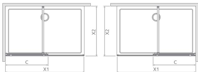
В случае монтажа на поддоне или бортик ванны, минимальная ширина плоской и ровной поверхности необходимой для монтажа составляет 43 мм а её наклон не более 1 мм.
