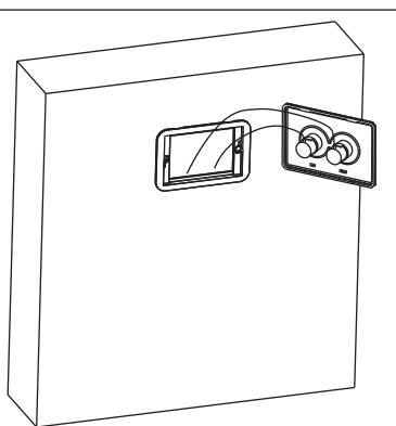
2: Присоедините шланг смесителя к воздушному насосу на панели смыва. Зеленый впускной шланг должен крепиться к воздушному насосу, отмеченному зеленым цветом. Белый впускной шланг прикрепляется к белому воздушному насосу.
