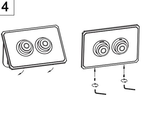
4: Закрутите два винта в нижней части панели смыва.
