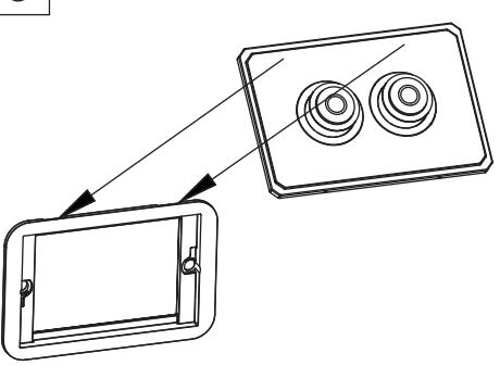
3: Наденьте верхнюю часть панели смыва на монтажную раму. Закрепите нижнюю часть панели смыва на монтажной раме.
