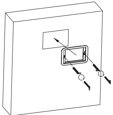
1: Установите монтажную раму для панели смыва на водяном бачке в положении для сборки и закрепите ее затяжным винтом.
