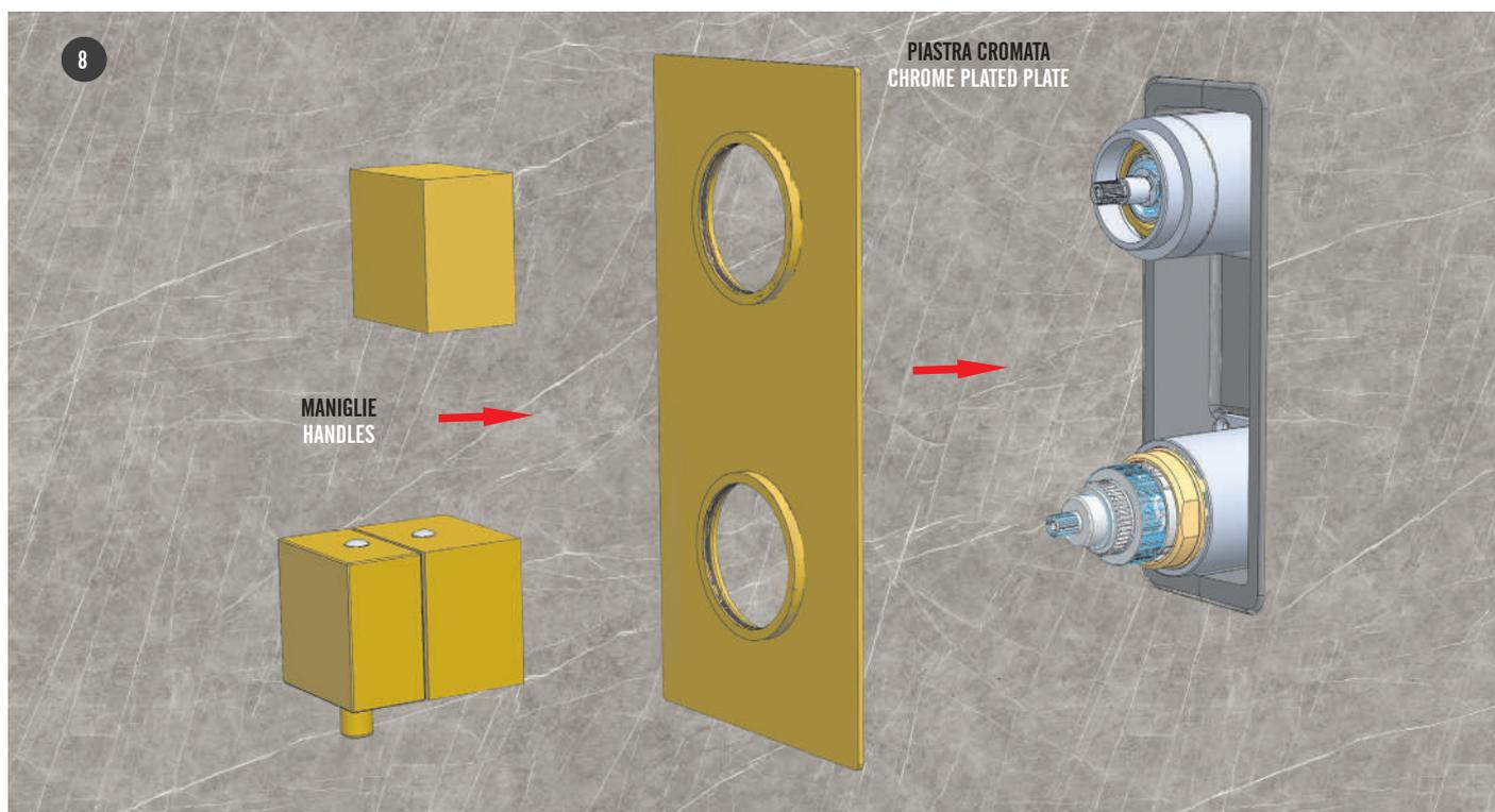
Montare la piastra cromata e le maniglie per completare l'installazione.
