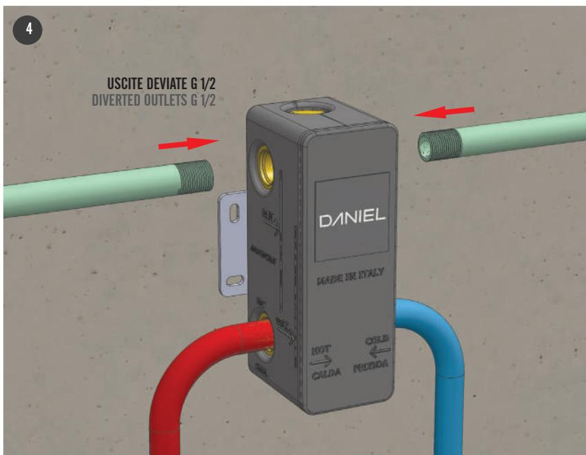
Collegare le 2 tubazioni laterali ( in verde nel disegno) delle uscite deviate da G 1/2.
