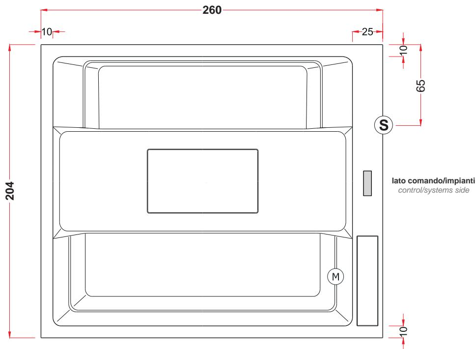
Valvola di scarico (S) Draining valve
