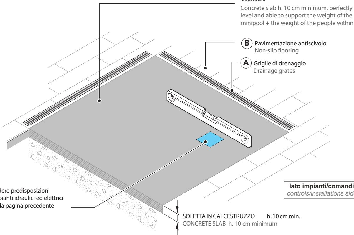
**Installazione ad incasso / Built in installation**
