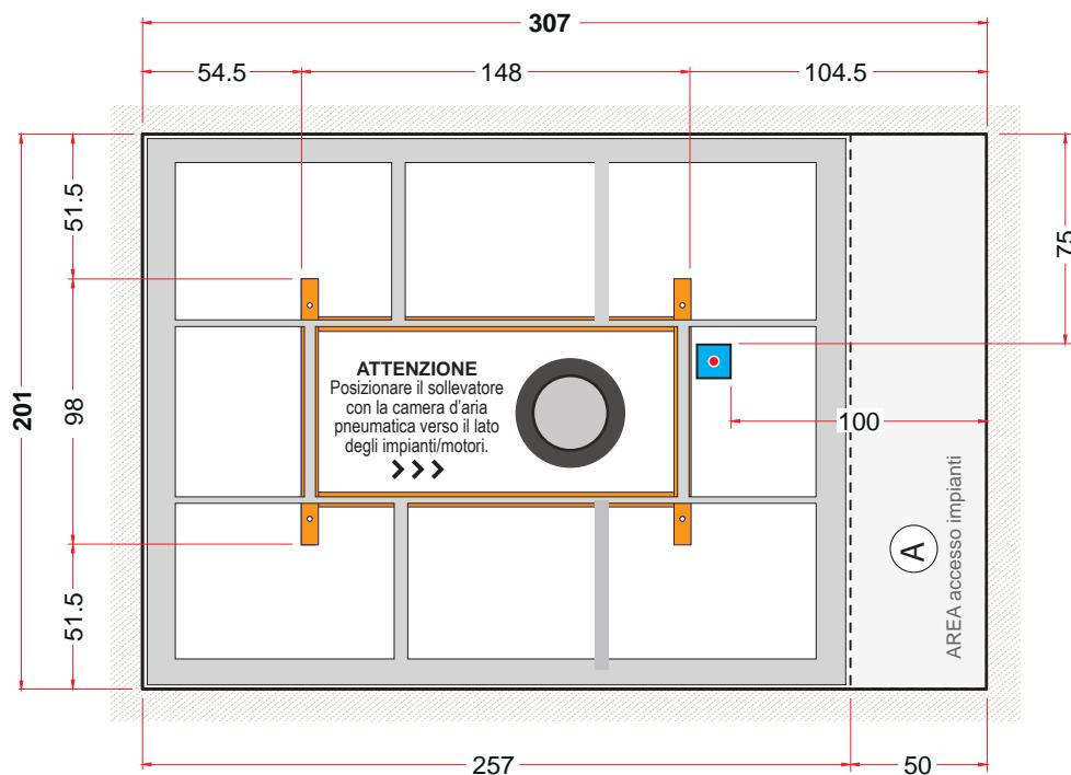
PROVVEDERE AL FISSAGGIO A TERRA DEL SOLLEVATORE SOLO DOPO AVER FATTO LA PROVA DI ESCURSIONE CON IL SOLO CONTROTELAI.
