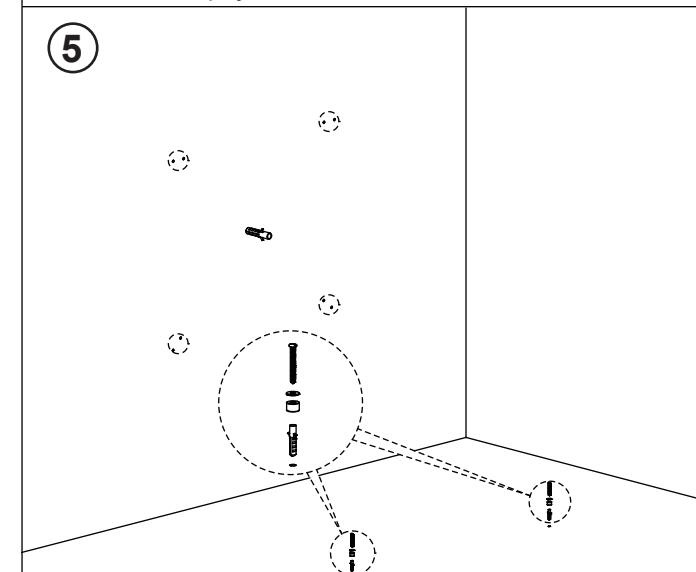
С помощью сверла просверлите отверстия.
