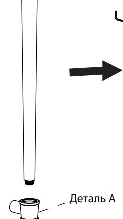
Наденьте деталь А на обе опоры и закрепите ее, затянув установочный винт.
