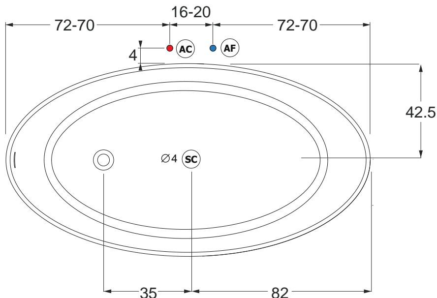
Allaccio acqua calda nel caso di vasca provvista di rubinetteria **(AC)** Hot water connection should the bathtub be fitted with taps
