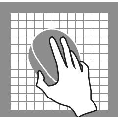
Перед началом укладки следует подготовить поверхности на которые будет укладываться мозаика. Поверхность должна быть идеально гладкой.
