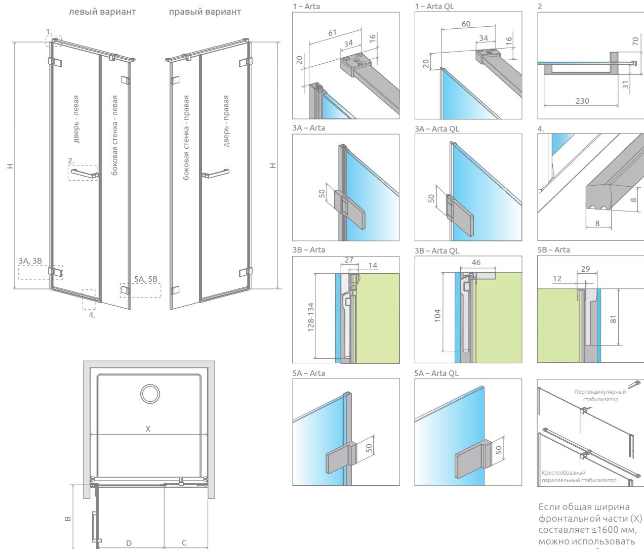
Если общая ширина фронтальной части (Х) составляет  $\leq 1600$  мм, можно использовать два типа стабилизатора – перпендикулярный или крестообразный параллельный (поставляется в стандартной комплектации). Этот вариант должен быть четко обозначен в заказе.
