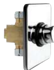
TE30Q Rubinetto per doccia incasso temporizzato quadrato, 1/2", in ottone, tempo d'apertura 18-20 secondi. Temporized (timer) wall mounted squared tap, 1/2", opening time 18-20 seconds.
